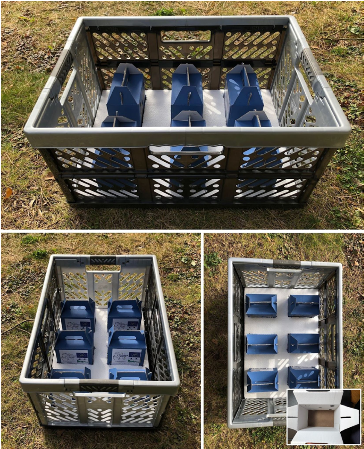
Figura 4.1. Cajas de transporte de cartón contenidas en la caja de plástico donde están inmovilizadas gracias a una base de poliestireno de alta densidad de 2cm de grosor. Las cajas de cartón presentan cinco orificios de 15 mm de diámetro en uno de sus laterales, así como el suelo revestido con una lámina de goma eva para evitar que las aves resbalen en el cartón. Todo el conjunto es cubierto con una malla de sombreado que reduce la entrada de luz en las cajas a la par que mantiene la ventilación.
